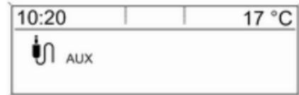
Источником звукового сигнала, подключенным ко входу AUX, можно управлять только с помощью органов управления этого источника.
