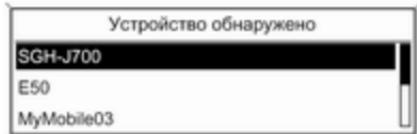
Выбрать требуемый мобильный телефон в списке. На дисплей информационно-развлекательной системы выводится приглашение к вводу пароля SAP, содержащего 16-значный код.
