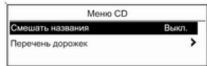
Повернуть многофункциональную ручку, чтобы отметить включаемую или выключаемую функцию.
