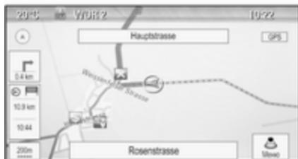
Для удаления навигационного следа, созданного в текущей сессии отслеживания, нажмите экранную кнопку **Удал**. На экране отобразится окно сообщения. Подтвердите сообщение об удалении всего навигационного следа.
