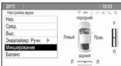
Чтобы отрегулировать распределение громкости между передними и задними динамиками автомобиля, выберите в меню пункт **Микширование**. Отрегулируйте настройку.
