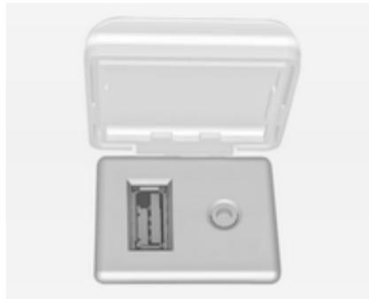
На центральной консоли имеется гнездо USB для подключения внешних источников аудиосигнала.
