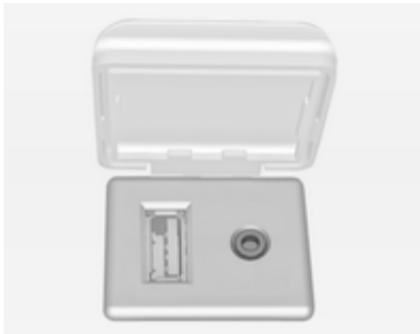
На центральной консоли имеется гнездо AUX для подключения внешних источников аудиосигналов.
