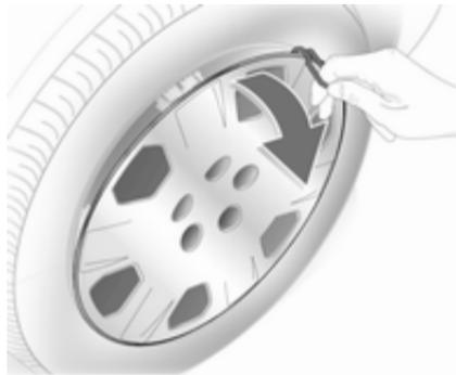
1. Снимите колесный колпак с помощью крюка. Автомобильный инструмент ⇨ 186.
