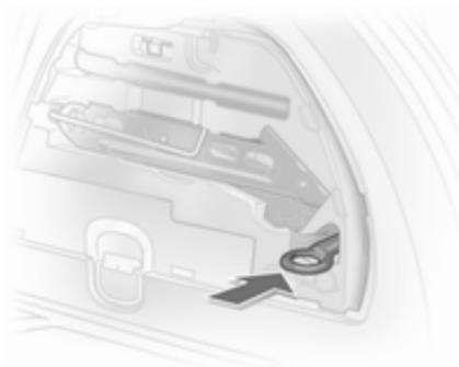
Буксирная проушина хранится в комплекте инструментов ↪ 186. Буксирная проушина расположена в уступе.
