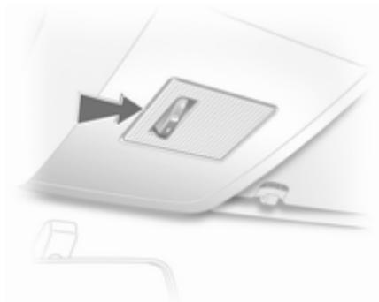
1. Освободите и снимите линзу в месте, указанном на рисунке, при помощи отвертки.
