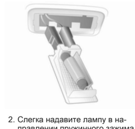
2. Слегка надавите лампу в направлении пружинного зажима и выньте ее.
