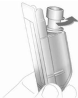
4. Поверните патрон лампы против часовой стрелки, пока он не освободится.
