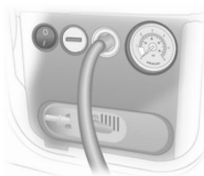
8. Нажмите кнопку включения-выключения компрессора. Шина заполнится герметиком.
