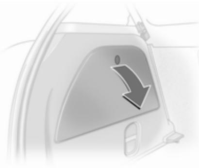
Блок предохранителей находится под крышкой на левой стенке багажного отделения. Снимите крышку.
