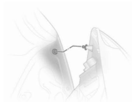
9. Установите корпус лампы в кузов автомобиля и затяните крепежные гайки вручную. Подключите разъем жгута проводов. Закройте крышку.
