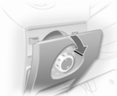
Блок предохранителей расположен за выключателем освещения. Потяните за верхний край панели и сложите его.
