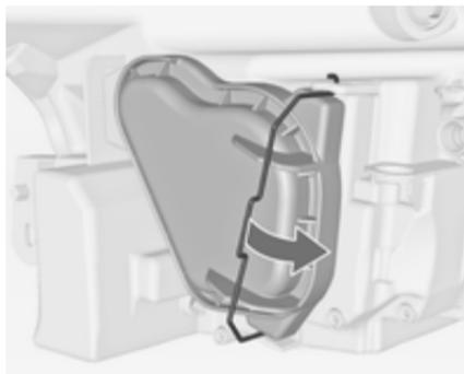
1. Снимите зажим проводов и удалите защитную крышку 1.
