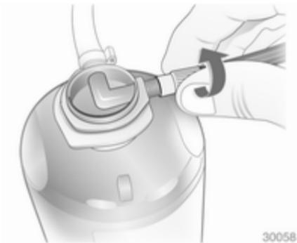
2. Размотайте шланг с кронштейна и наверните его на штуцер баллона с герметиком.
