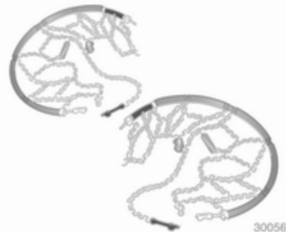
Цепи противоскольжения разрешается применять только на передних колесах.
