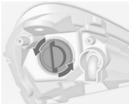
1. Поверните держатель лампы накаливания **3** против часовой стрелки и отсоедините его.
