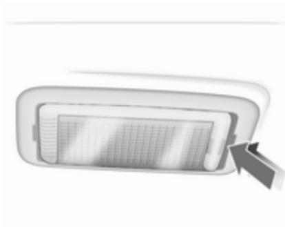
1. Выдавите фонарь с помощью отвертки.
