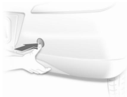
Отцепите крышку снизу и снимите вниз.
