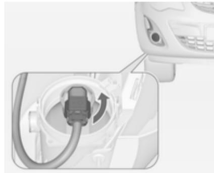
1. Повернуть патрон лампы против часовой стрелки и извлечь его из рефлектора.
