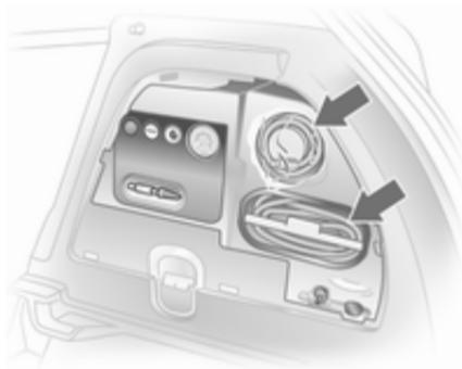
1. Выньте из вкладыша баллон с герметиком и кронштейн с воздушным шлангом.
