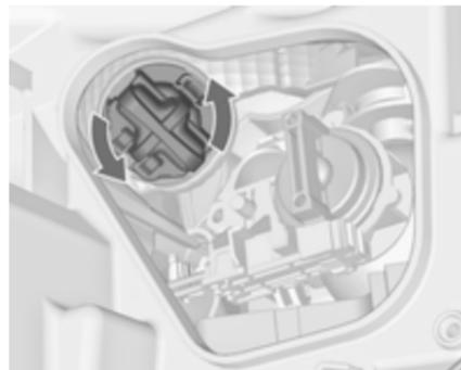
2. Поверните патрон лампы против часовой стрелки, пока он не освободится.
