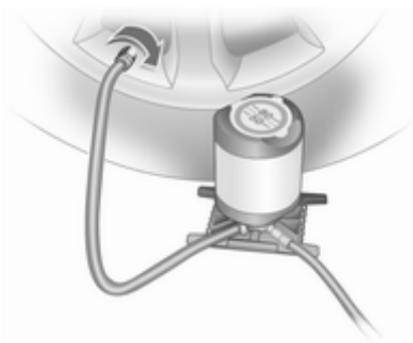
4. Отверните колпачок вентиля поврежденной шины.
