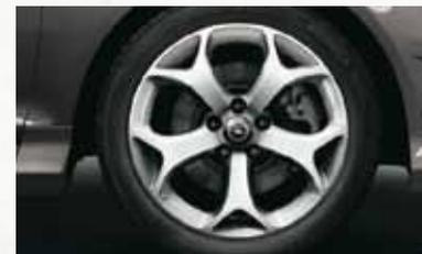
Легкосплавные колесные диски, 7 J x 17, 5-Y-образных спиц OPC, шины 215/45 R 17 (PNJ). Стандартное оборудование для OPC.
