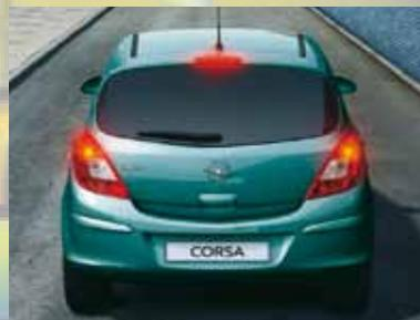
**Адаптивная система стоп-сигналов.** На скорости свыше 30 км/ч при срабатывании системы ABS стоп-сигналы начинают мигать, чтобы предупредить о резком торможении.
