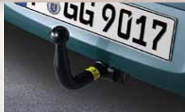
**Быстросъемный фаркоп.** Легко устанавливается и будет почти незаметным на вашем новом Opel Corsa. Позволяет, в зависимости от объема двигателя, буксировать прицеп массой до 1300 кг.
