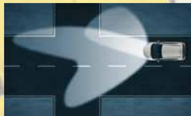
**Статическое освещение при поворотах.** При повороте на низкой скорости включается дополнительное освещение под углом 90° в правом или левом направлении.
