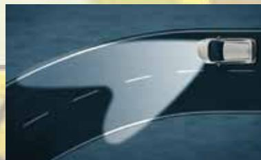
**Динамическое освещение при поворотах.** Фары поворачиваются на угол до 15° в зависимости от угла поворота и скорости движения автомобиля, что позволяет лучше видеть дорогу.
