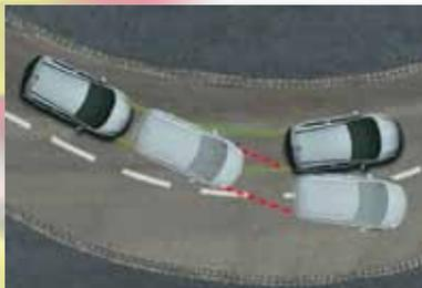
**Система динамической стабилизации (ESP<sup>Plus</sup>).** В новом Opel Corsa опционально может использоваться система ESP<sup>Plus</sup>, в которую входит противобуксовочная система (ТС<sup>Plus</sup>) и усовершенствованная система контроля недостаточной поворачиваемости автомобиля (ЕUC). Данная система оптимизирует маневренность автомобиля, повышая функциональность обычной системы ESP<sup>®</sup>.
