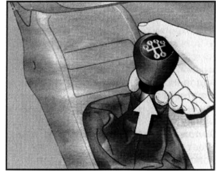
22.1 На рычаге переключения передач РКПП для включения передачи заднего хода необходимо нажать кольцо фиксатора
