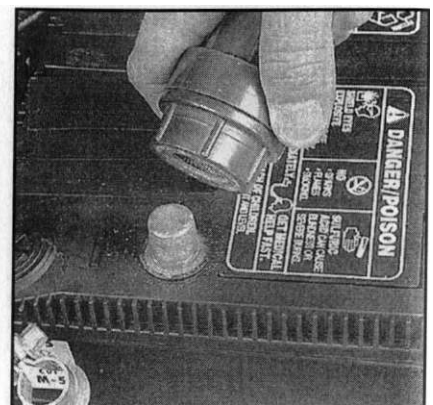
11.10б Зачистка полюсной клеммы
