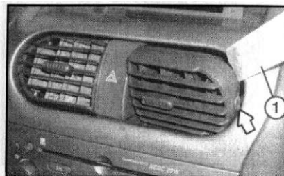
10.2b Снятие центрального дефлектора при помощи пластмассового клина (1) (модели Corsa C)
