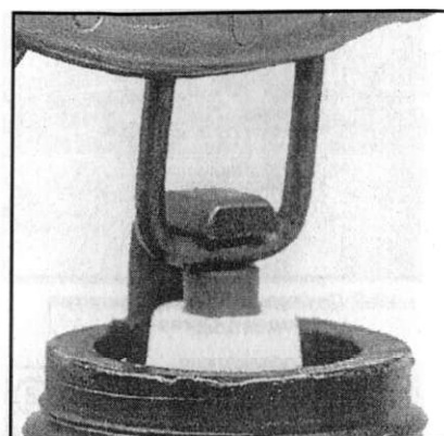
22.10a Проверка величины межэлектродного зазора при помощи измерителя проволоочного типа
