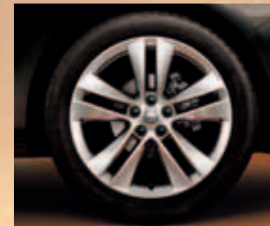
Колесо с 18-дюймовым легкосплавным диском 5 двойных спиц, с серебристой отделкой. Предназначено для шин 225/45 R 18 или 235/45 R 18. Типоразмер колеса: 7,5 J x 18 или 8 J x 18.
